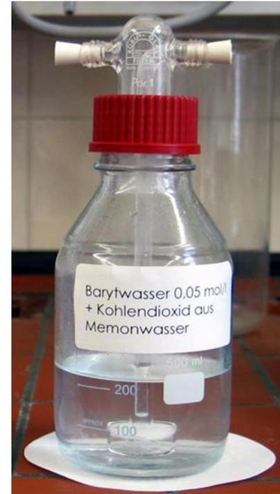
Abbildung 2: Rückflussapparatur mit Gasüberleitung in eine Gaswaschflasche
